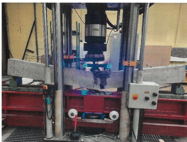
Rys. 1. Wyboczenie stalowego pręta zbrojeniowego w ściskanej strefie żelbetowej belki poddanej trójpunktowemu zginaniu (badania własne recenzenta i jego doktoranta)
